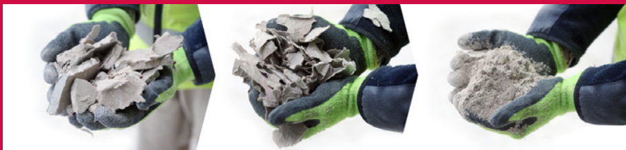
New West Gypsum Recycling verwerkt het afval van gipsplaten tot enerzijds papier dat weer gerecycled wordt, en gipspoeder dat opnieuw gebruikt wordt voor de productie van gipsplaten
